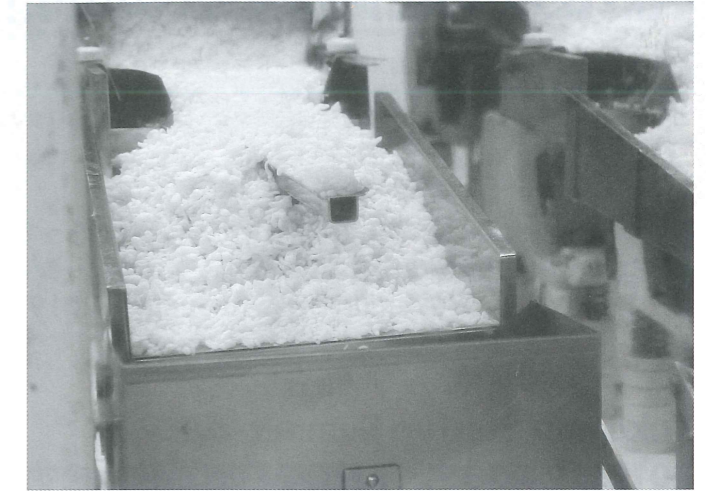
焦げ目のある天カスをエアノズル(写真中央)を使い吹き飛ばす
